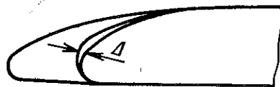
Рис. 8.44. Профилирование носовой части крыла с предкрылком
